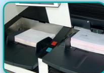
**Doppelanlagensystem** mit jeweils 1.000 Blatt Anlagekapazität. Ermöglicht eine kontinuierliche Belegzufuhr und unterbrechungsfreies Scannen.
