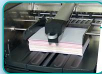
**Doppelablagensystem** mit automatischer Ablage bis 130 mm Stapelhöhe, Sortierfunktion, aktiver Luftabsaugung und verstellbarem Papieranschlag.
