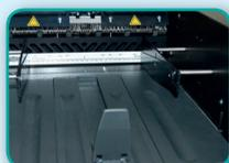
**Belegablage** für geordnetes Stapeln der gescannten Belege ohne Geschwindigkeitsverlust. Bis 130 mm Stapelhöhe mit aktiver Luftabsaugung, verstellbarer Papieranschlag und asymmetrisch einstellbare Papierführungen.
