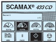
Scangeschwindigkeit ganz einfach per Tastendruck am Display zu ändern.
